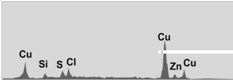
Figura 3. Espectro EDS realizado sobre los productos de corrosión de una moneda sin tratar.
