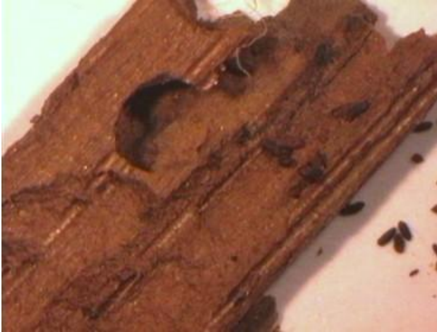
Fig. 3 – Restos de madera atacada por anóbidos, galerías, 7X
