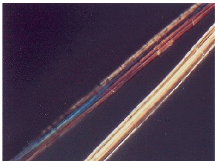
Figura III.2.12. Fibras de cáñamo. Fotomicrografía al microscopio óptico con luz transmitida del tejido de la pieza inferior, 200x.
