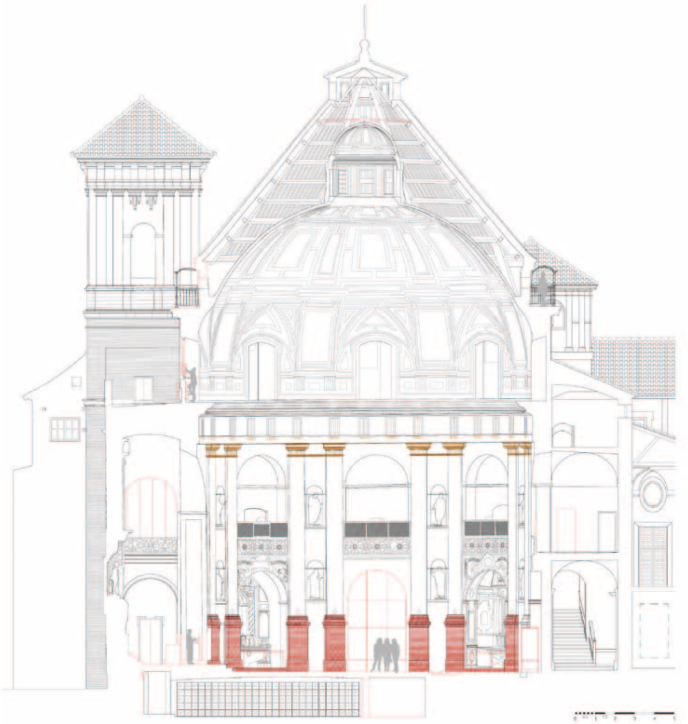
Sección norte. Estado actual y propuesta. Plano: Fondo Gráfico IAPH (Departamento de Proyectos IAPH)
