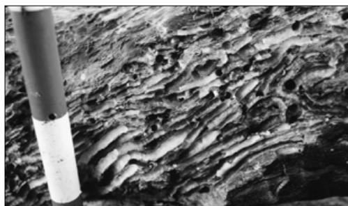
Detalle de las galerías excavadas por el "teredo" en la pieza de madera.
