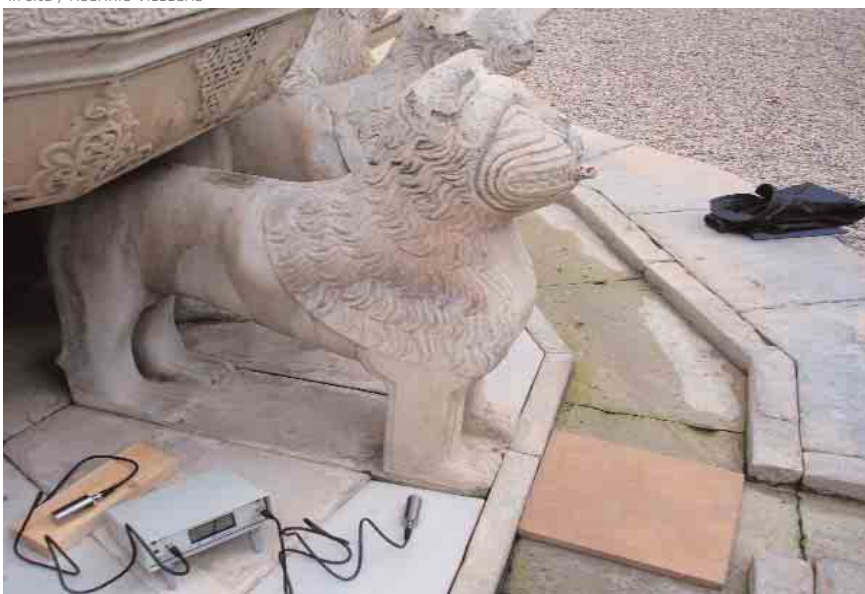
Realización de estudio de propagación de ultrasonidos in situ / ROSARIO VILLEGAS
