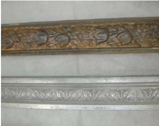
Dos matrices de abultado para molduras, en acero y aluminio. Foto: Eugenio Fernández Ruiz, IAPH
