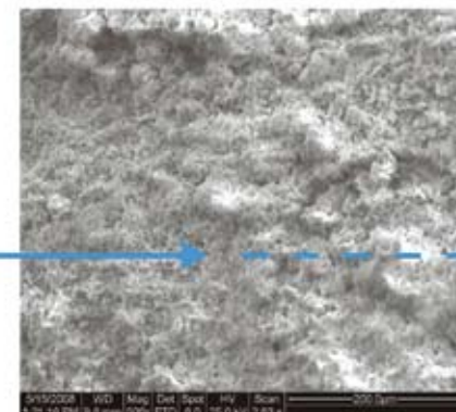
Imágenes SEM y espectros EDS característicos de los distintos óxidos depositados sobre la superficie de una muestra del grupo M1. Fuente: Departamento de Ciencia de los Materiales e Ingeniería Metalúrgica y Química Inorgánica. Universidad de Cádiz
