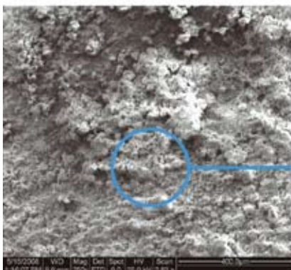
Imágenes SEM y espectros EDS característicos de los distintos óxidos depositados sobre la superficie de una muestra del grupo M1. Fuente: Departamento de Ciencia de los Materiales e Ingeniería Metalúrgica y Química Inorgánica. Universidad de Cádiz
