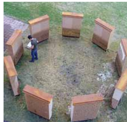
Durante un año se evaluó la resistencia de nueve bloques de tapial. Foto: David Muñoz de la Calle
