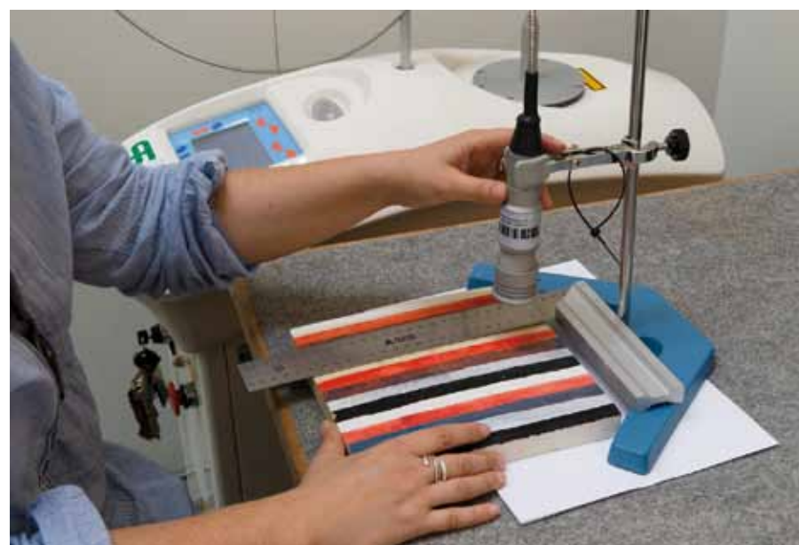
Estudio de limpieza láser en sistemas modelos. Fuente: Fondo Gráfico IAPH (José Manuel Santos)
