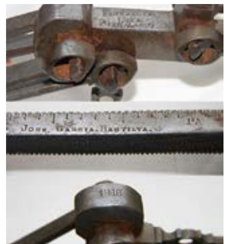
Romana de forja de tres ganchos realizada por encargo. Cincelados el nombre del propietario, el del artesano y la fecha de fabricación
