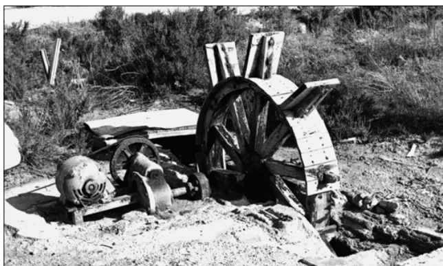
7. Noria para el remonte del agua de las cabeceras antes de la limpieza de los cristalizadores.
