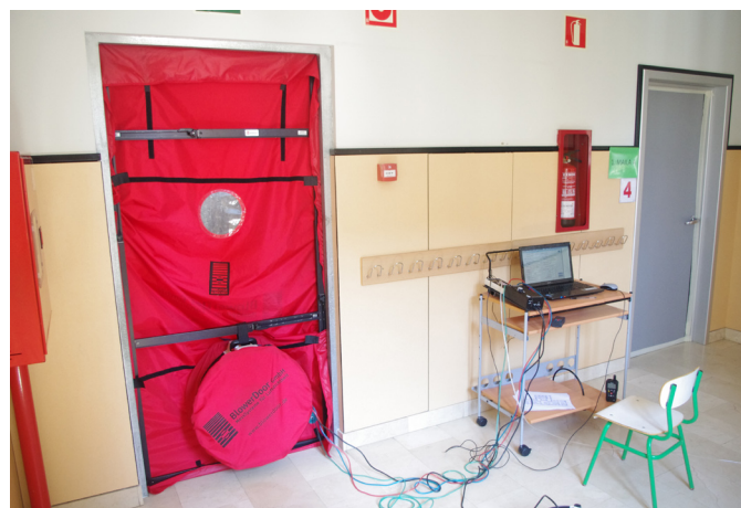
Edificio Escuelas Zuloaga de la c/ Aldamar n.º 3a (San Sebastián). Aspecto exterior del edificio y análisis frente a la estanqueidad al aire mediante el ensayo Blower Door Test de una puerta ventilador (junto con la instrumentación auxiliar de portátil, medidores de presión y temperatura, etc.) que se sitúa en los marcos de las puertas existentes para medir el caudal de infiltraciones que atraviesa la envolvente del edificio | fotos los autores
