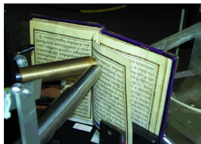
Fig. 14. Detalle del dispositivo experimental durante los análisis XRF del libro.
