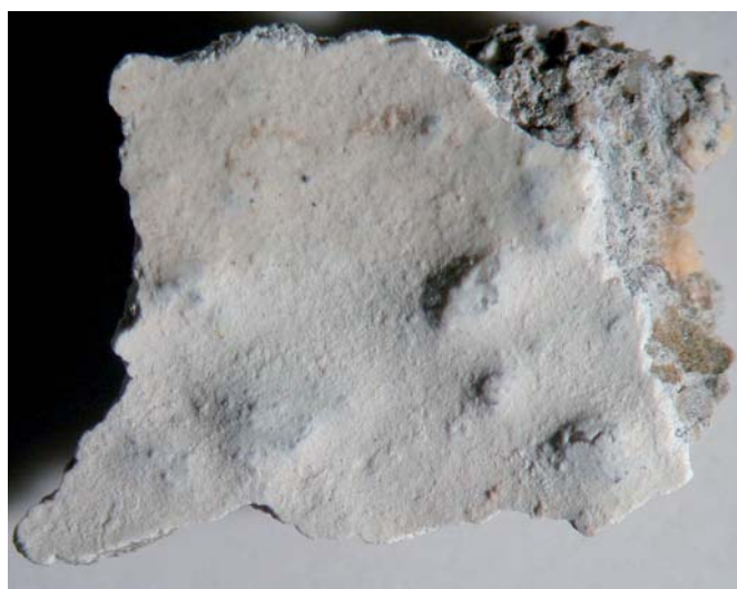
Casa Tugendhat, terraza superior, fachada. Detalle de la superficie original y una muestra de cal reciente de 2011, que se pigmenta con las partículas finas de arena regional. La lechada de cal original de color blanco amarillento en la pared rallada es tan delgada que el color de los granos de arena juegan un papel en el color general del mortero. Fotos: HAVK / Hammer (izquierda) y Hitzler (derecha)
