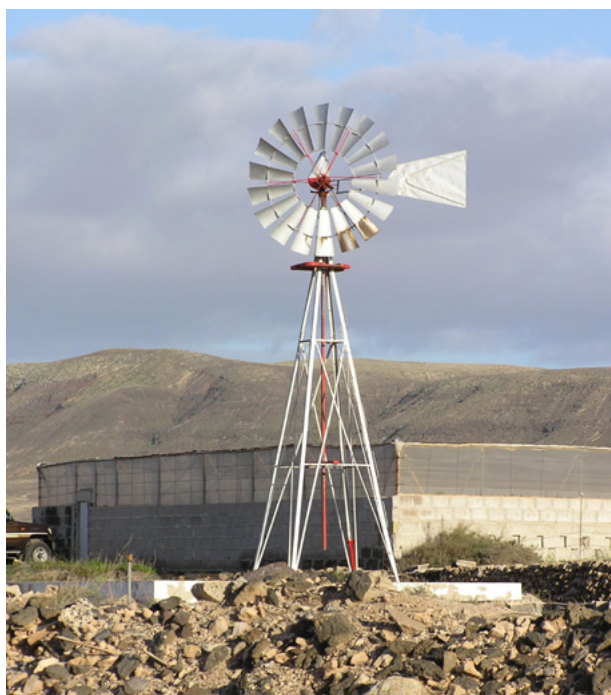
Imagen 12] Aeromotor o molino americano. Término municipal de La Aldea, Gran Canaria. Foto: Juan Manuel León Afonso
