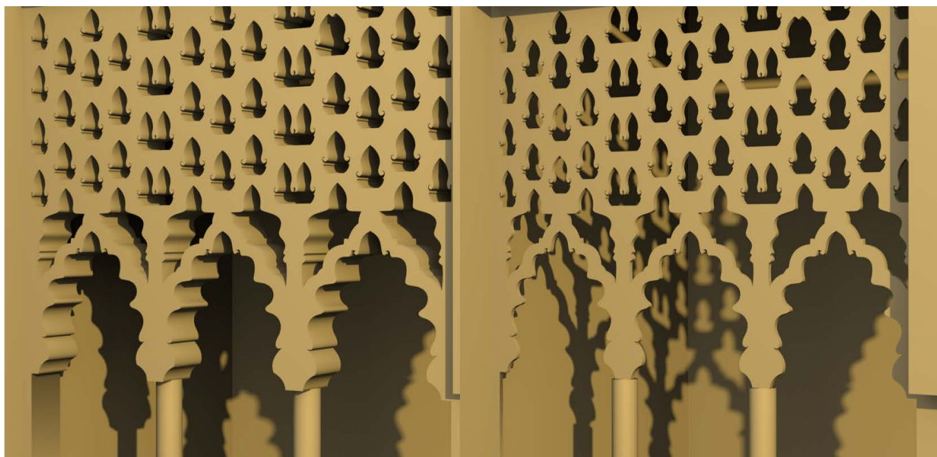
Simulación de retención de rayos solares por la celosía del Patio del Yeso (Real Alcázar). En dos supuestos: actual (izquierda) y celosía de poco grosor (derecha) | fuente elaboración propia sobre modelo 3D obtenido de fotogrametría. Proyecto PMAA
