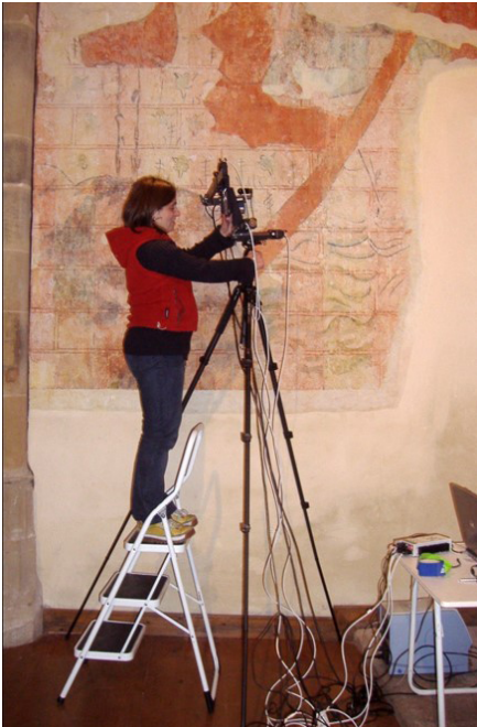
Micro espectroscopia Raman sobre una pintura mural, a más de dos metros de altura, en la iglesia gótica-renacentista de Goikolexea, Bizkaia. Los cables blancos mandan los pulsos eléctricos a los tres motores que mueven la sonda en las direcciones X-Y-Z para obtener un enfoque adecuado
