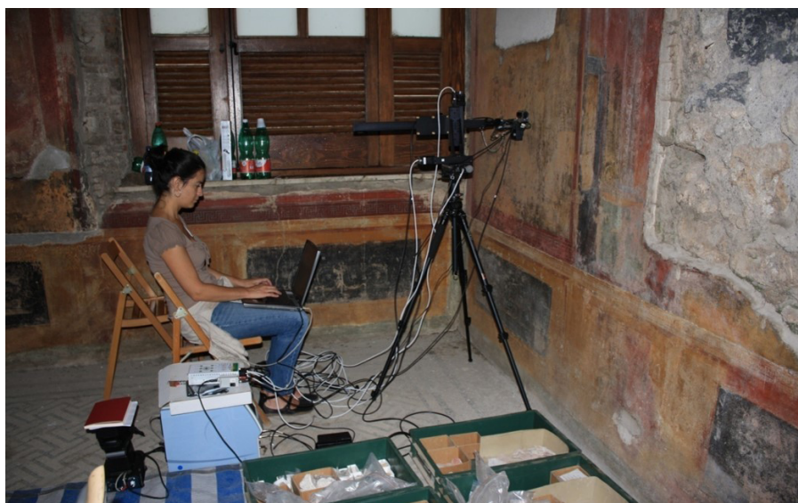
Microscopia Raman analizando una pintura mural de la que casi no se aprecian sus trazos y detalles. Pero se puede saber qué pigmentos se usaron analizando a nivel microscópico los granos que todavía están en la pared. Las zonas blancas de las paredes son eflorescencias que salen de su interior por causa de los ataques ácidos
