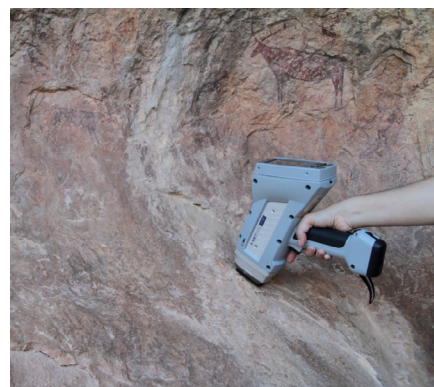
Sistema portátil de EDXRF trabajando sobre un pictograma rojizo conservado en la pared natural del abrigo Cañaica del Calar, Moratalla, Murcia
