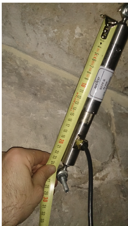
Modelo de fisurómetro para control estructural | fuente Fundación Santa María la Real del Patrimonio, de todas las imágenes que ilustran este artículo si no se indica lo contrario
