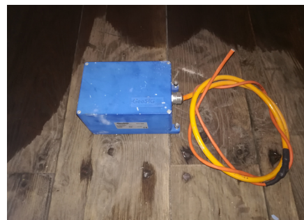
Acelerómetro instalado para el control de vibraciones en las pinturas del Panteón Real
