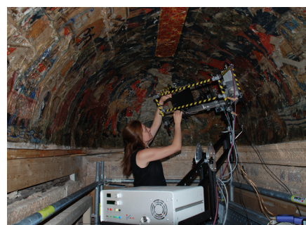
Análisis no invasivo mediante difracción de rayos X y fluorescencia de rayos X portátil para la caracterización de las pinturas de la Sala de la Reyes en la Alhambra (Granada) | foto Fondo gráfico IAPH (Auxiliadora Gómez Morón)
