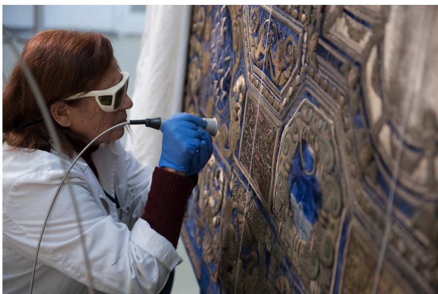
La limpieza láser de los hilos metálicos permite una limpieza precisa y controlada de forma no invasiva, eliminando la suciedad y los contaminantes sin dañar el material original | foto Fondo gráfico IAPH (Eugenio Fernández Ruiz)
