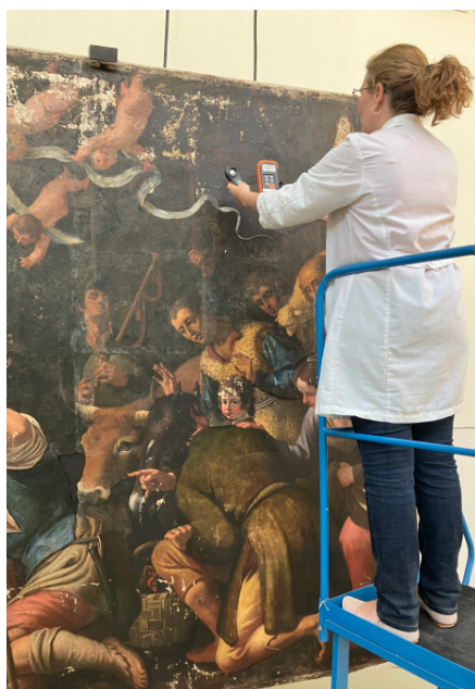
Medición de luz con luxómetro | foto Fondo gráfico IAPH (Lourdes Fernández)
