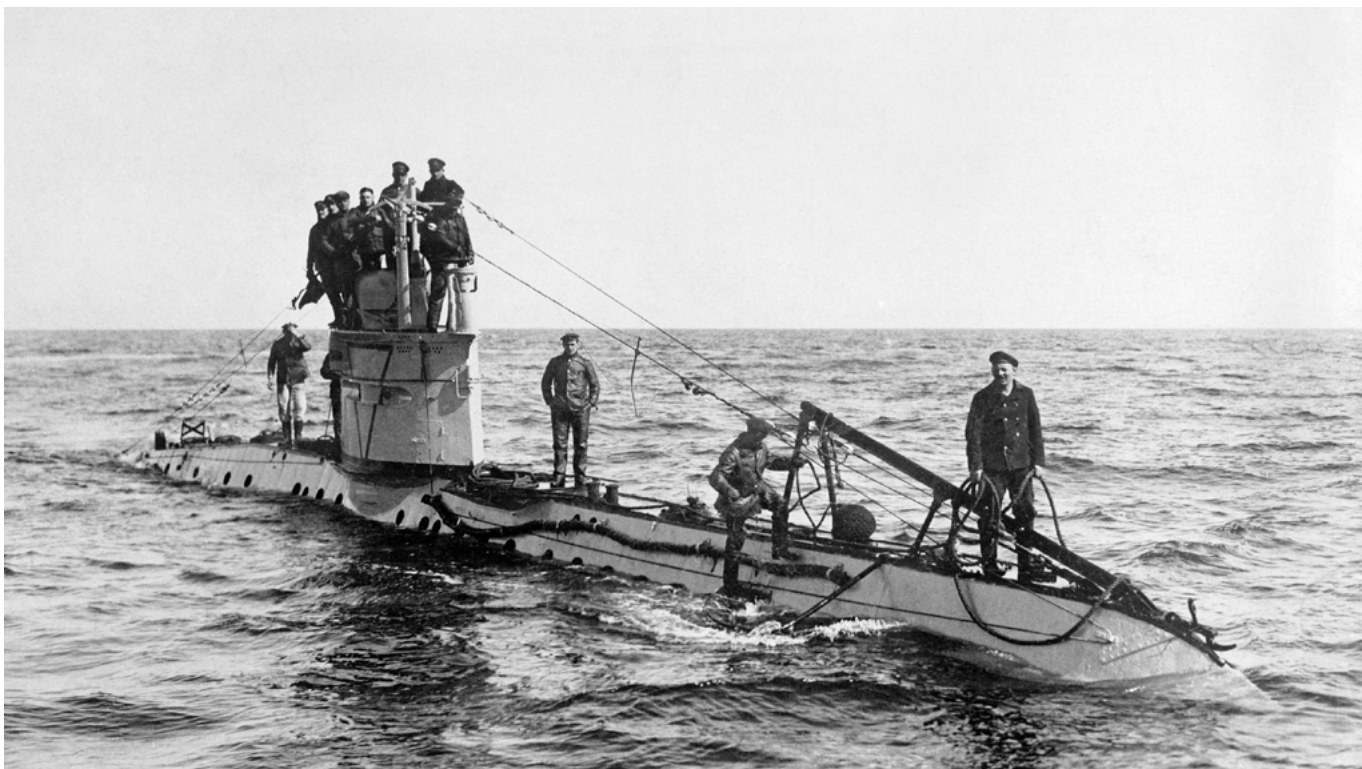
Submarino (clase UC-1) de la Armada Imperial Alemana, encargado de sembrar minas durante la Primera Guerra Mundial | foto Museos Imperiales de la Guerra (Mark Cartwright)
