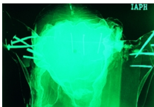
Fotos 9 y 10: Radiografía de la cabeza donde se aprecian los elementos metálicos y restos de policromía subyacente.
